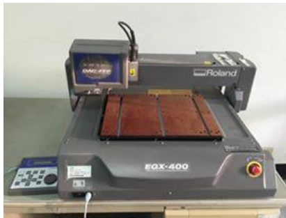
圖 2、三軸高速薄板雕刻機
