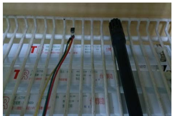
圖 5-13 左-1820 感測器右-數位溫度感測器
