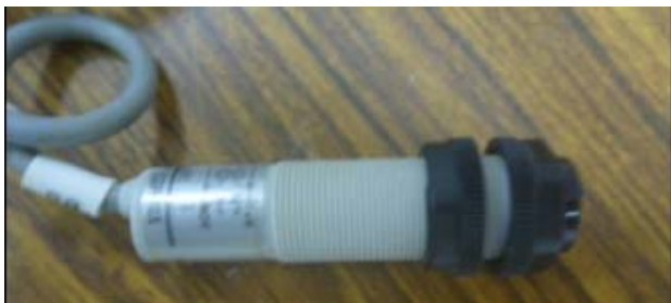
圖 8：光電擴散型感測器
