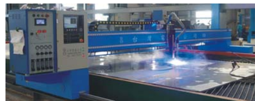
圖十 CNC 電離子切割機
