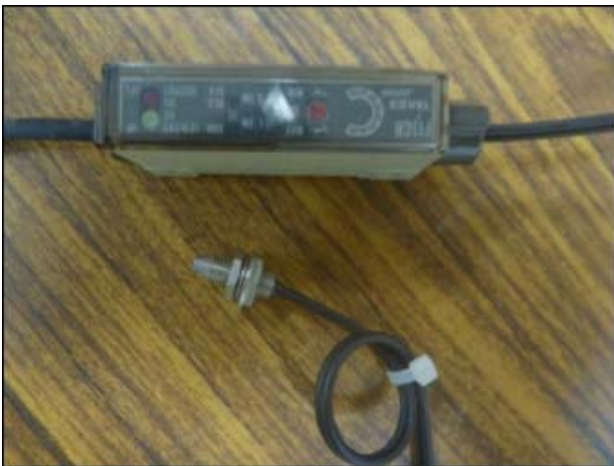
圖 13：光纖擴散反射型感測器
