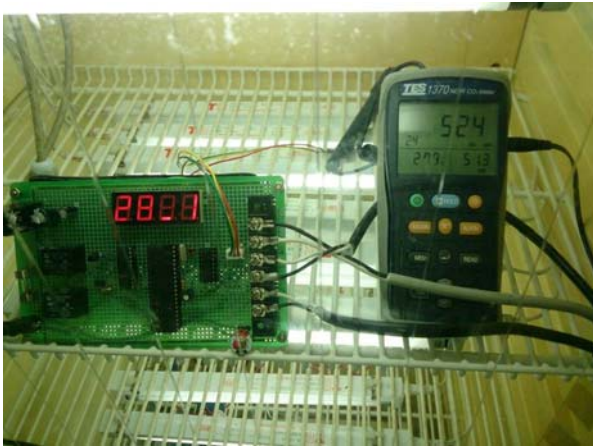
圖 5-15 在製作成品時，程式部分也做了更動，當感測溫度高於 28 度時，便啟動降溫裝置(以白光代表驅動狀態)
