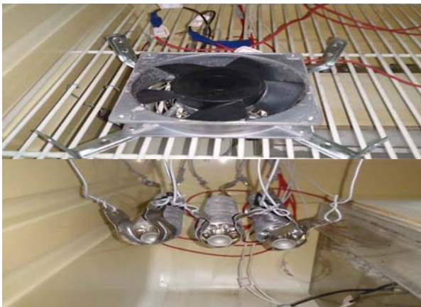
圖 5-10 升溫裝置(加熱器) 當下方加熱器啟動後,由風扇往上排出,以達到熱空氣循環效果
