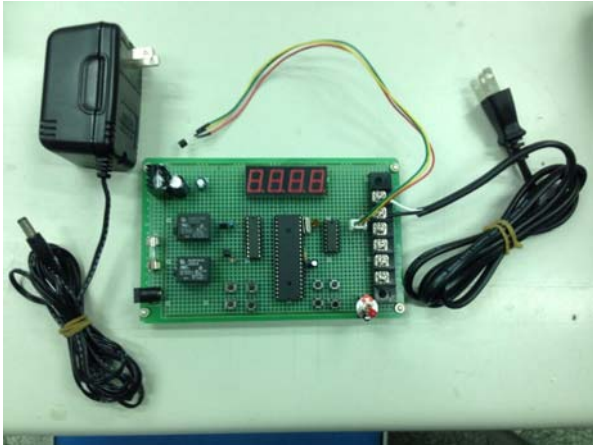
圖 5-8 實際電路板 以 110V(黑線)輸入,經過 IC7805 做降壓以維持穩壓輸出
