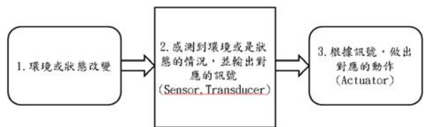
圖 1：典型的感測作業流程 [1]
