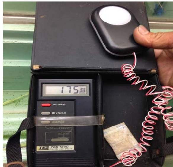
圖 12 光照計量測光的強度
