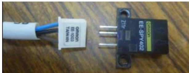
圖 9：光遮斷擴散反射型感測器
