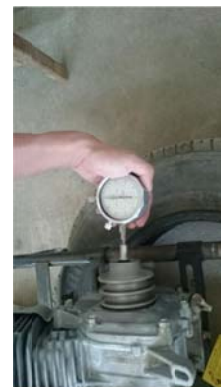
圖六、數位轉速錶是以點火訊號作為量測
