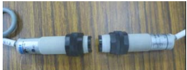
圖 5：光電對照反射型感測器
