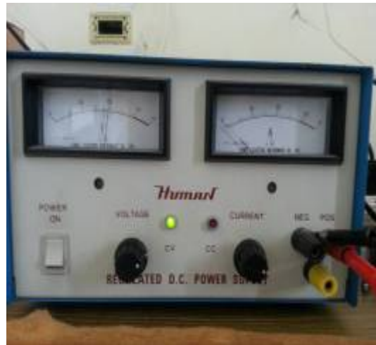
圖 9: 電源供應器設定電壓
