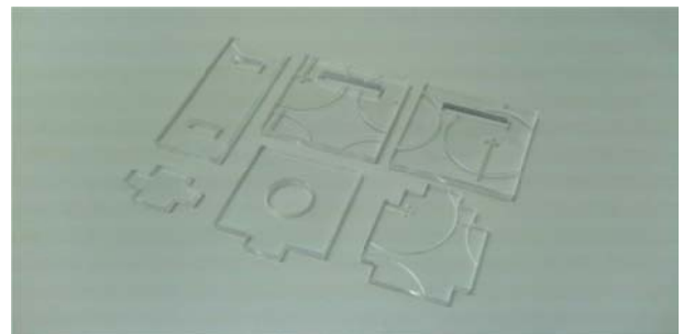
圖 7 傳動座的模型組件
