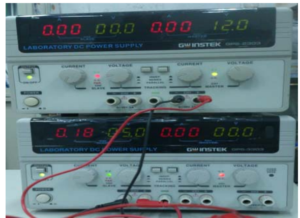
圖 5-5 電源供應器 上方電源供應器供給風扇 下方電源供應器供給模擬面包板和 LED
