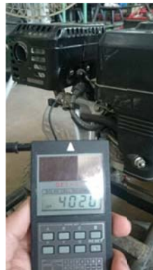
圖六、數位轉速錶是以點火訊號作為量測
