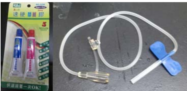
圖 10-2、使用 AB 膠將對半的注射用蝴蝶針黏貼至封裝好的壓克力。
