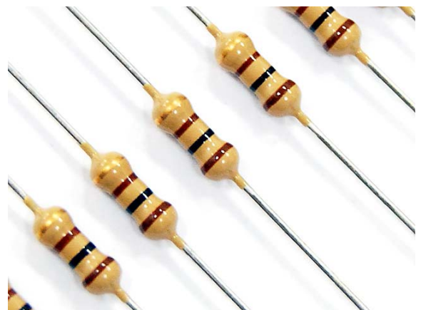
圖 6、電阻 330Ω：預防燒毀 LED
