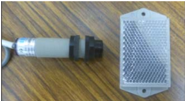
圖 7：光電鏡片反射型感測器
