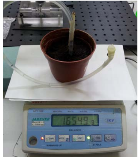
圖十二 毛細水管的製作量測圖
