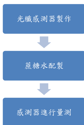
圖 6 未鍍膜光纖感測器的流程圖
