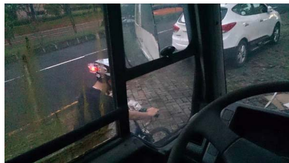
圖三十三 大貨車左側視野死角測試角度 1
