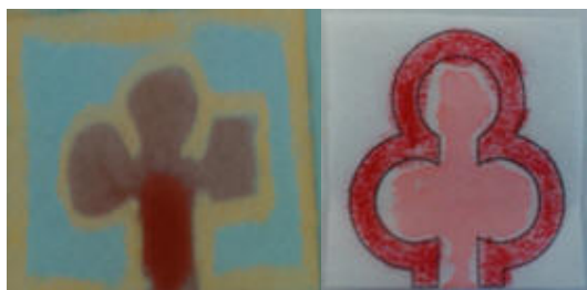
圖十九、(a) 手繪單層式紙晶片結果圖、(b) 電繪單層式紙晶片結果圖
