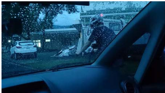
圖二十九 轎車右側視野死角測試
