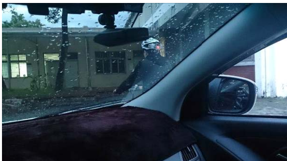
圖三十一 休旅車右側視野死角測試
