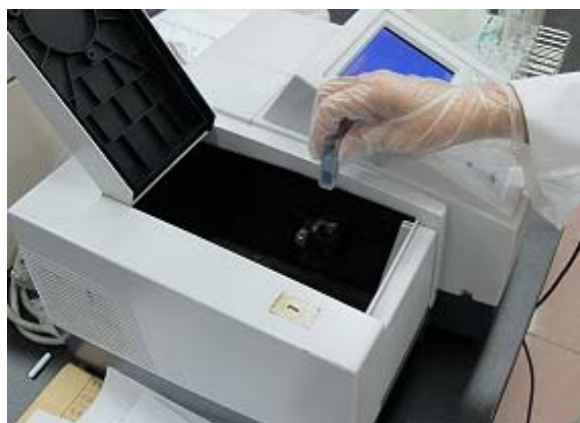
圖 4 以分光光度計進行多酚含量檢測示意圖
