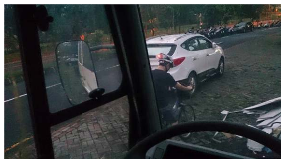
圖三十四 大貨車左側視野死角測試角度 2
