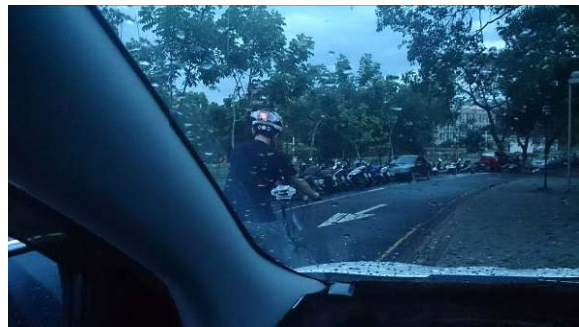
圖三十二 休旅車左側視野死角測試
