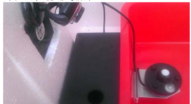
圖十六 超音波霧化器、光量子計與 CCD 擺放位置
