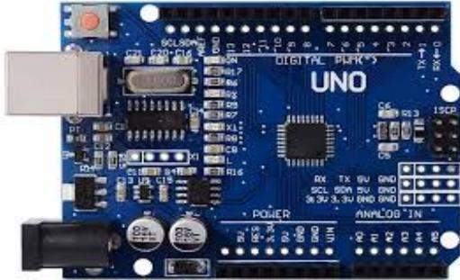
圖 2.1.6 Arduino Uno 板
