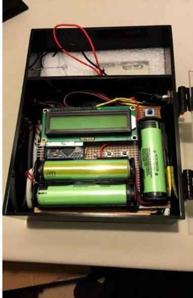
這是我們做出來的成品利用 Arduino 做出微小的電路板以及面板上可以作溫度控制幾度的調整，上面也有加熱燈顯示和溫度顯示，加熱棒放在鋁塊裡面對檢體加熱，能在一分鐘之內加熱到 65 度，為了解決電力問題和環保問題我們用鋰電池可以一邊加熱一邊充電並不用拔下來充，另外下面還有一組電池以防電池沒電可以隨時切換電源，上面有按鈕可以增減溫度設定我們要的溫度，最上方的那個鋁塊是放檢測體的區域，上面有外加蓋子以防溫度流失太快，也有紫外線燈泡能達到即測即評，原本大機器外加電力問題而不能帶出去外面檢測的物品，我們簡化成攜帶簡易也不用擔心電力問題，操作方法簡單讓每個人都學的會怎麼操作。
