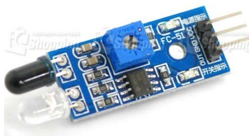
圖 5 38khz 紅外線發射接收模組
