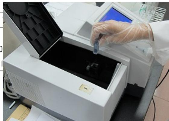
(圖 13)以分光光度計進行多醣含量檢測示意圖
