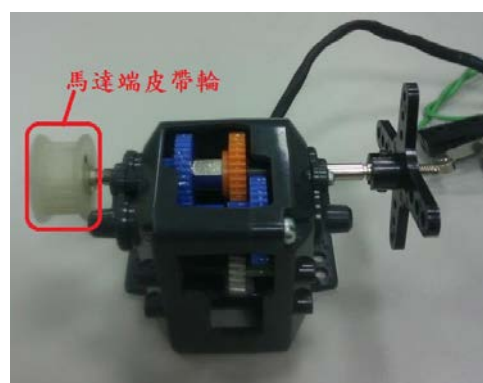
圖十 直流馬達加齒輪組實體圖
