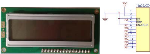
圖5、文字型LCD腳位功能表與外觀
