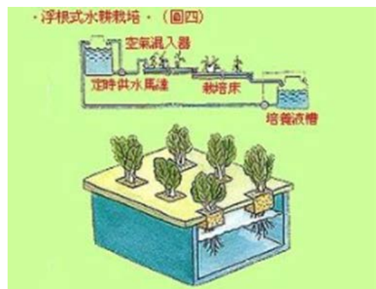
圖 5、浮根式水耕栽培示意圖 (出自 http://blog.udn.com/PMCBOS/7255710 )
