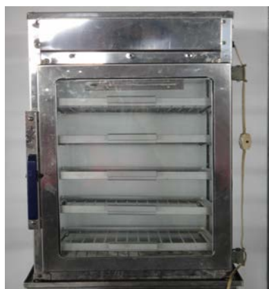
圖 2、氣態二氧化氯處理機構
