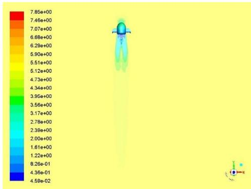
圖 3-9 仿鯉魚魚尾在流速 5m 流場方向 0 度的速度分佈
