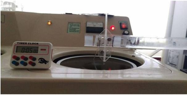
圖七 雙盤研磨機研磨光纖端面
