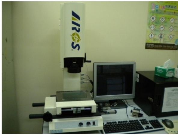
圖八 非接觸式影像量測儀
