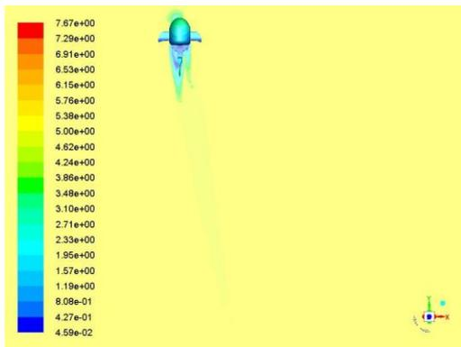
圖 3-10 仿鯉魚魚尾在流速 5m 流場方向 15 度的速度分佈
