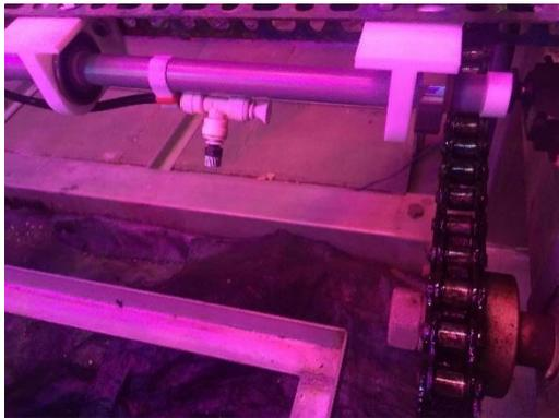
圖三 轉動式高壓噴水灌溉系統
