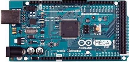
圖 4 Arduino MEGA 2560 控制板
