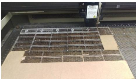
圖四 雷射加工光纖夾具
