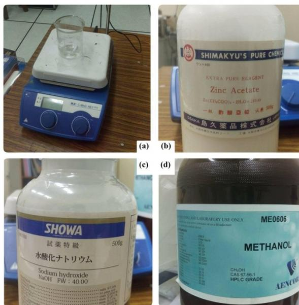
圖十七 配置氧化鋅溶液之設備
