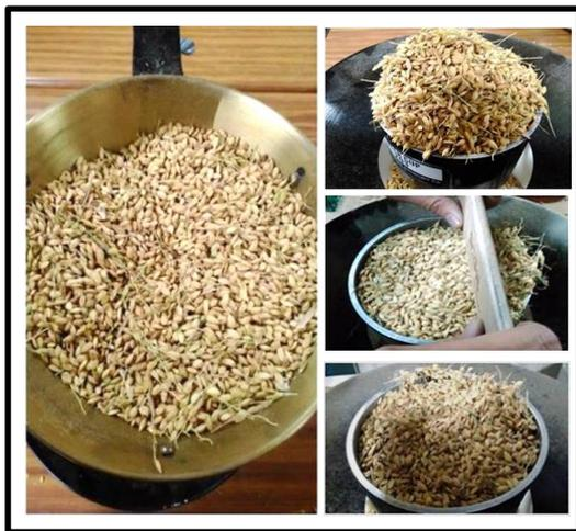
圖 14 雜質影響容重量測量之狀況
