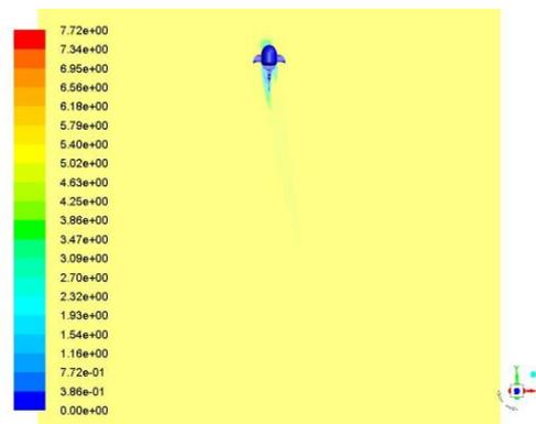
圖 3-14 仿小丑魚魚尾在流速 5m 流場方向 15 度的速度分佈
