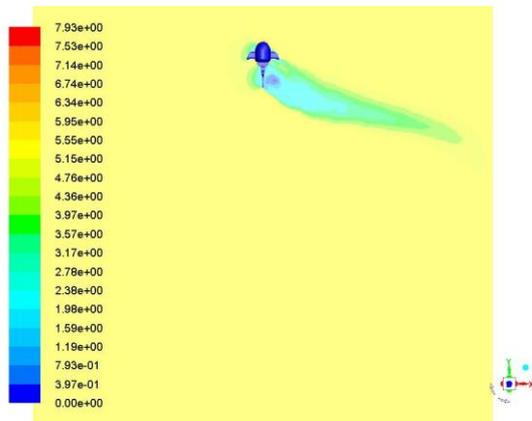
圖 3-16 仿小丑魚魚尾在流速 5m 流場方向 75 度的速度分佈
