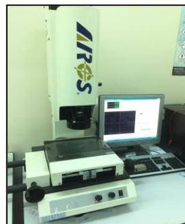
圖七 非接觸式影像量測儀
