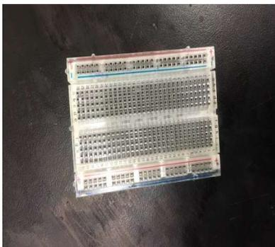
圖19. 免焊式測試電路板
