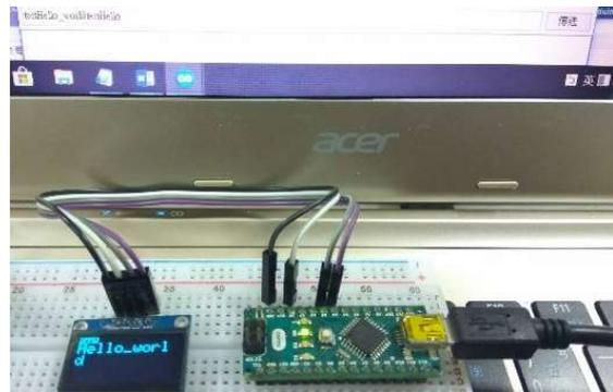
圖七. OLED 字串顯示測試圖
