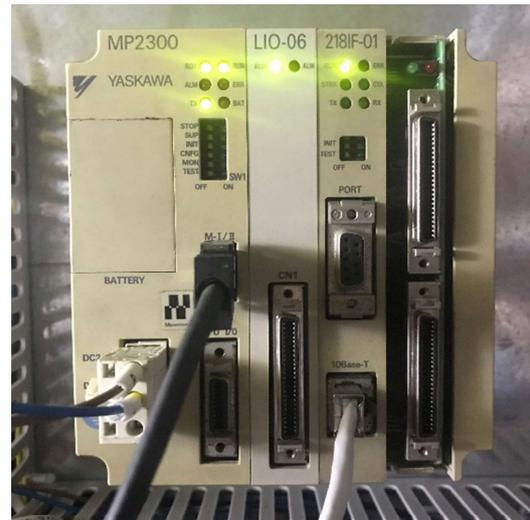
圖五、MP2300 運動控制器
