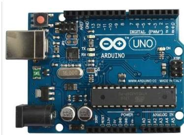
圖一 arduino uno 控制板 圖片來源:PanaVision
