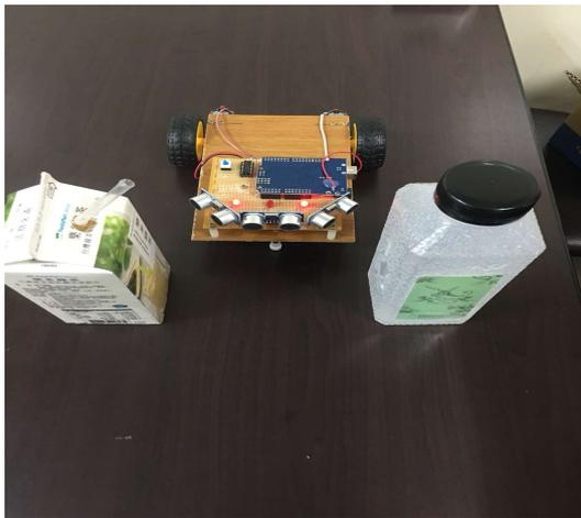
圖十、左、右方有障礙物(距離相同)
