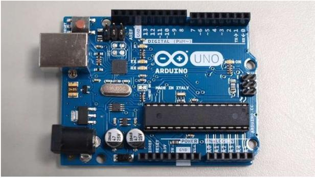
圖4. Arduino UNO R3 控制板
