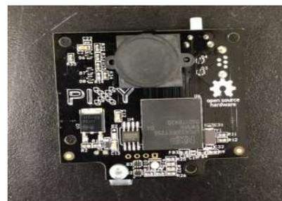
圖10. Pixy CMUcam5 高清攝像頭圖像識別感測器模組
