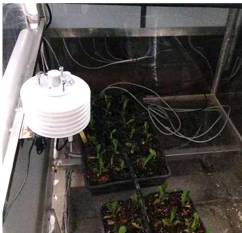
圖 3 溫室內之溫、濕度監控系統
