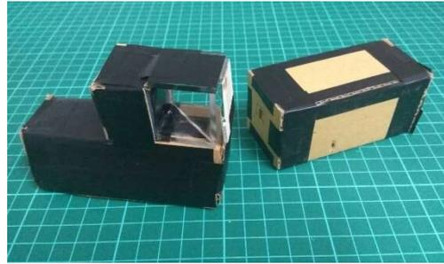
圖十一：頭戴式抬頭顯示裝置原型機
