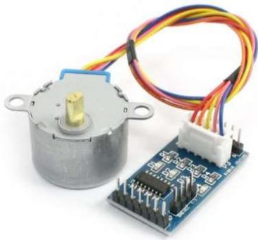
圖五 步進馬達圖片來源:台灣物聯科技
