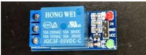
圖6. JQC-3F-5VDC繼電器
