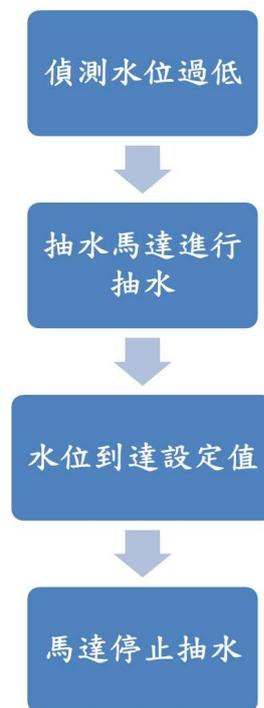
圖二 水位補液流程圖
