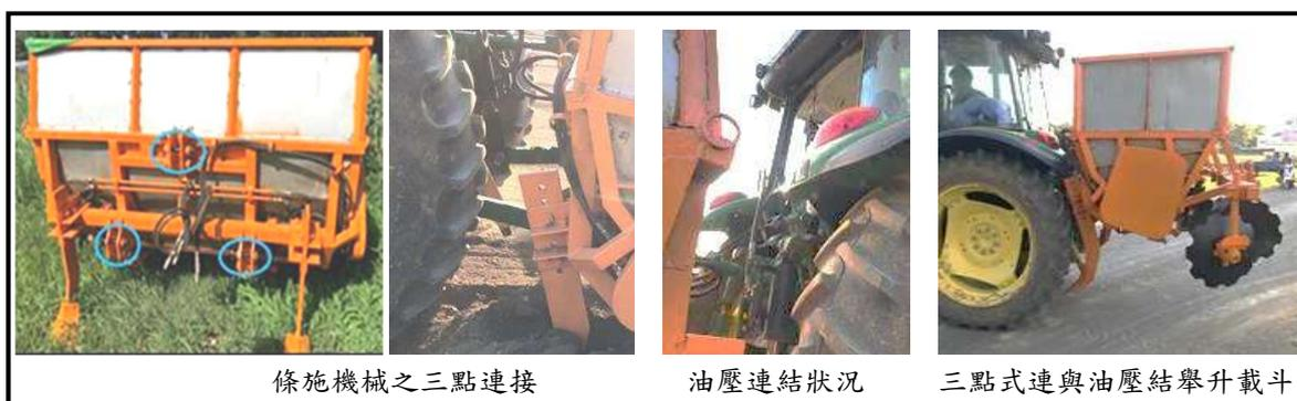
圖 2 條施機械與曳引機連接之狀況
