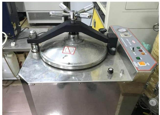
圖 3 高溫滅菌釜 規格: HIPOINT 25L。
