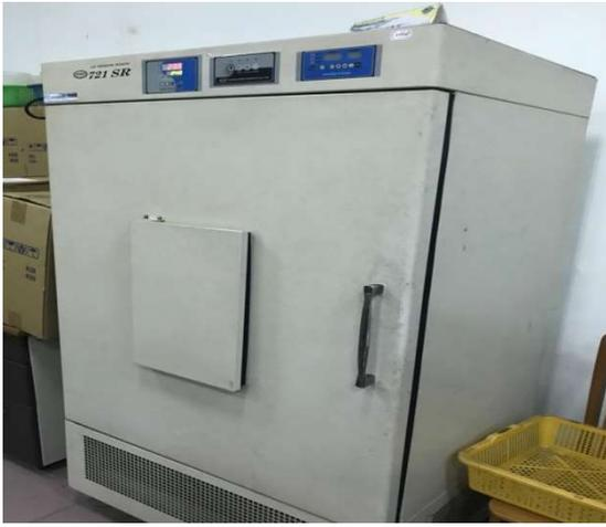
圖 4 不同溫度控制之恆溫培養箱 規格: HIPOINT 721SR。
