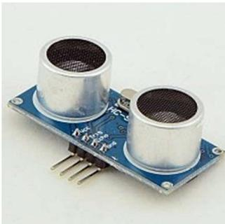
圖五 超音波感測器圖
