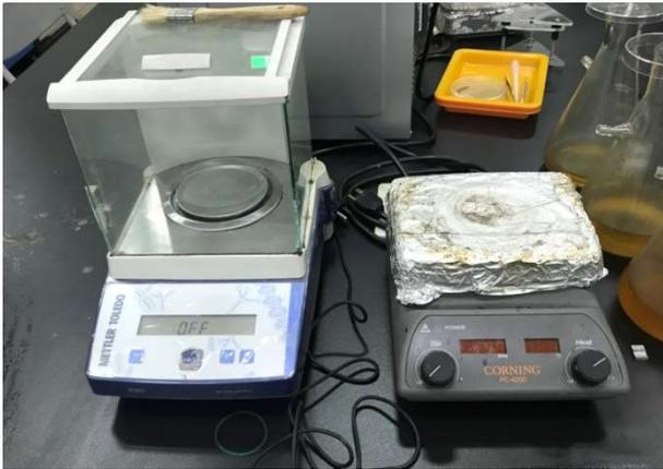
圖 5 加熱磁力攪拌器及電子秤重儀 規格: 精度 0.001 克。
